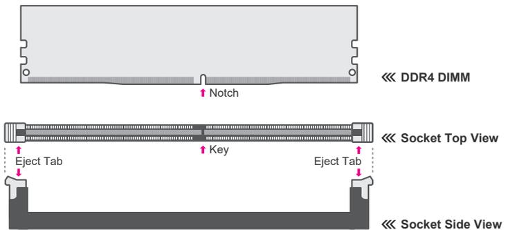
► System Memory ► Installing the DIMM Module
