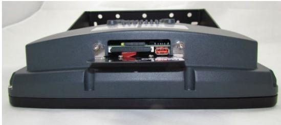
Abb. 8-6: WLAN, WWAN 3G-Antenne geöffnet
