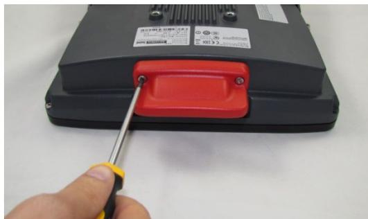
Abb. 8-3: WLAN-Antenne IEEE 802.11 a/b/g/n/ac öffnen
