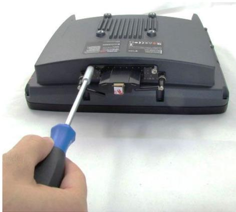
Abb. 8-8: Antennenmodul WLAN-, WWAN-Antenne öffnen
