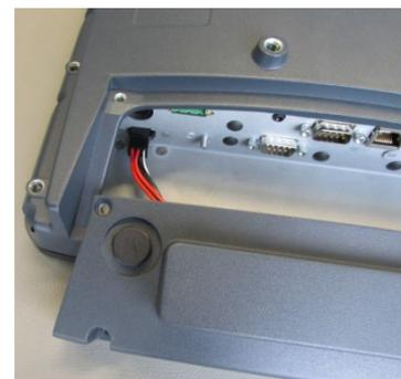
Abb. 15-11: Kabelabdeckung mit integriertem USV-Akku
