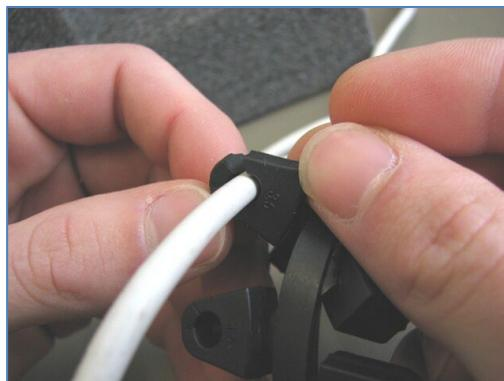
Fig. 15.4: Example cable grommet
