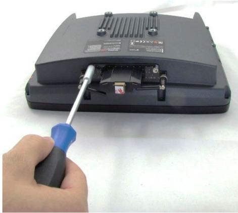
Fig. 8.7: Open WLAN / WWAN antenna
