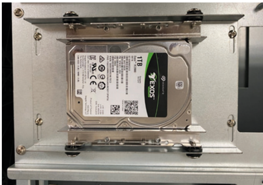
Figure 2.14 Installing 2.5" HDD bracket with chassis/ 组装 2.5" 硬盘支架于机箱上 / 組裝 2.5" 硬碟支架於機箱上
