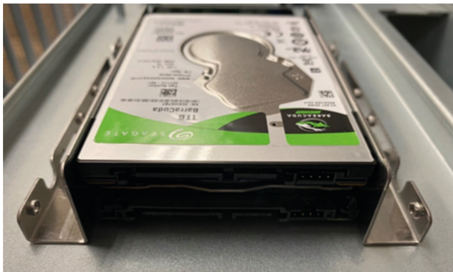
Figure 2.15 Installing 2 HDDs with brackets/ 安裝 2 個 2.5” 硬盘与支架 / 安裝 2 個 2.5” 硬碟與支架
