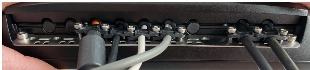
Abbildung 14-14: Kabelabdeckung geschlossen und verschraubt
