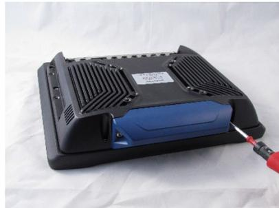
Abbildung 15-2: Antennenkappe demontieren
