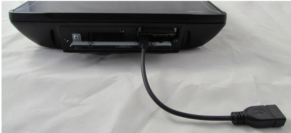
Abbildung 7-23: Angesteckter Adapter am USB Typ-C Service Port
