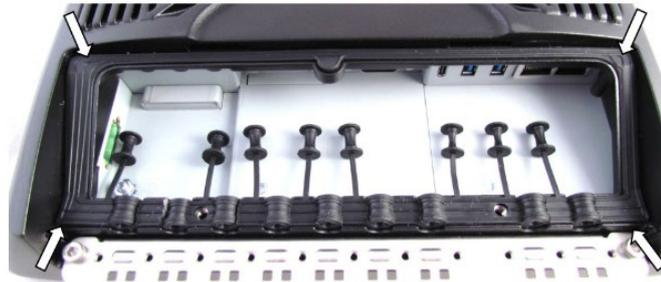
Abbildung 14-4: Dichtungsgummi in das Kabelfach eingelegt
