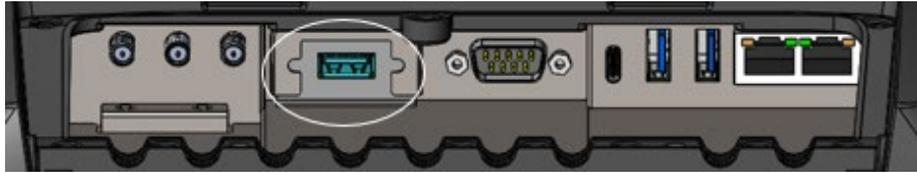
Abbildung 7-7: AddOn USB-A 3.2 Gen1 Schnittstelle
