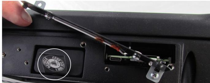
Abbildung 15-7: Akkupack in das Akkufach einsetzen
