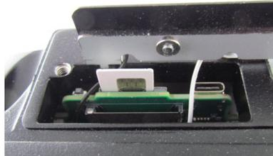
Abbildung 11-1: SIM-Karten-Slot unter der Antennenkappe
