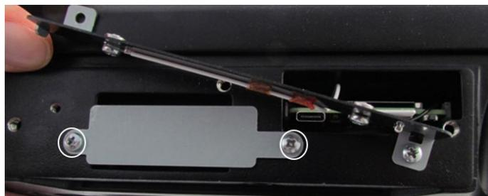
Abbildung 15-5: Befestigungsschrauben der Akkuabdeckung
