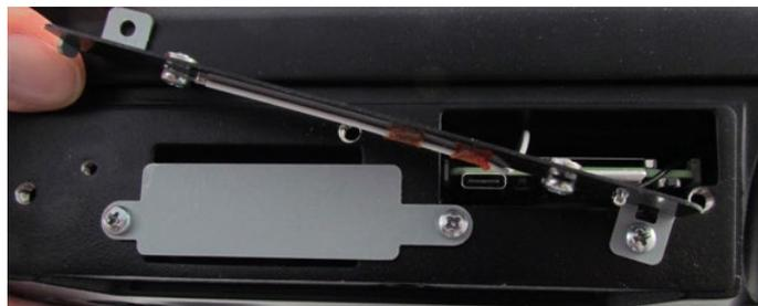
Abbildung 15-4: Geöffnete WLAN Diversity Antenne
