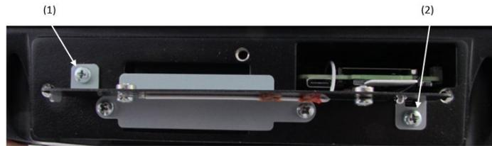
Abbildung 15-3: WLAN Diversity Antenne
