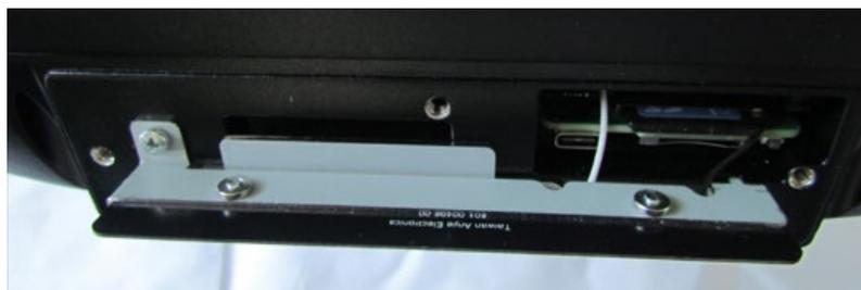
Abbildung 7-22: Geöffnete WLAN-Antennenkappe IEEE 802.11 a/b/g/n/ac
