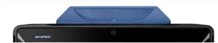
Abbildung 6-1: WLAN-Antenne
