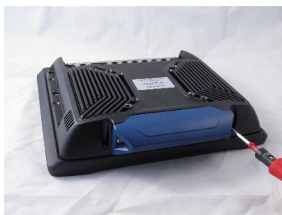
Fig. 15-2: Remove antenna cap
